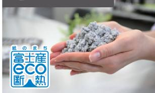
優れた気密&断熱性を発揮する、環境にもやさしい自社生産・施工の「富士産eco断熱」を標準採用。北海道レベルの性能(HEAT20 G2)をクリアするとともに、優れた防火、調湿、吸音効果も発揮します。
